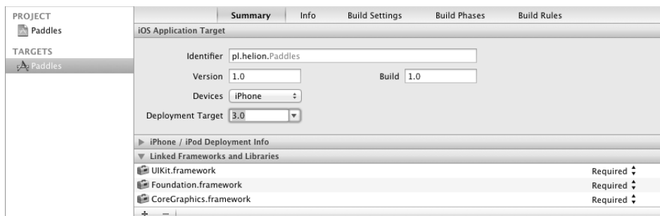
Rysunek 2.3. Ustawienia aplikacji oraz zdefiniowanie minimalnej wymaganej wersji systemu iOS
