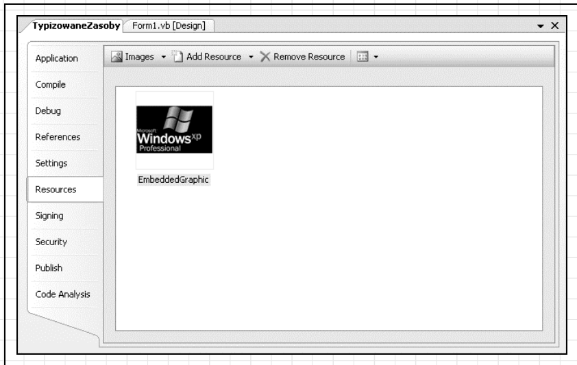
Rysunek 2.2. Dodawanie obrazu jako ściśle typizowanego zasobu
