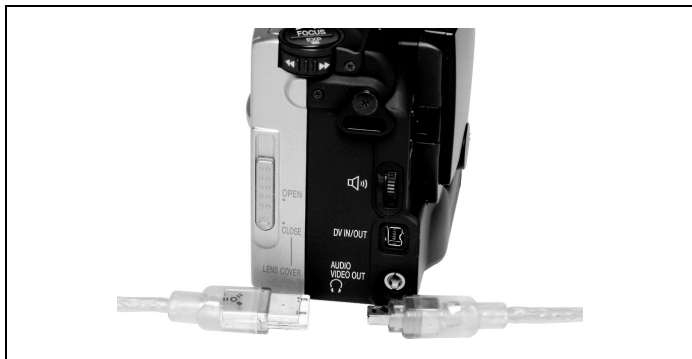
Rysunek 2.3. Do przesłania nagrania z kamery do komputera należy wykorzystać przewód FireWire (IEEE 1394), dzięki czemu zachowana zostanie wysoka jakość obrazu i dźwięku. Mniejszy wtyk należy umieścić w gnieździe kamery, większy zaś w porcie FireWire komputera
