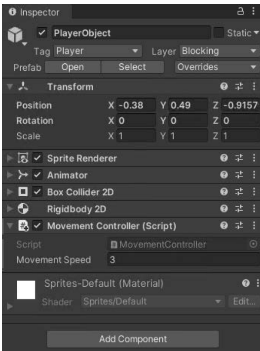
Rysunek 3.32. Publiczna zmienna movementSpeed wyświetlana z początkową wielką literą i spacją w środku
