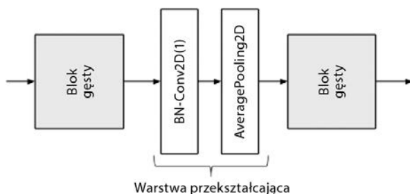
Rysunek 2.13. Warstwa przejściowa pomiędzy dwoma gęstymi blokami
