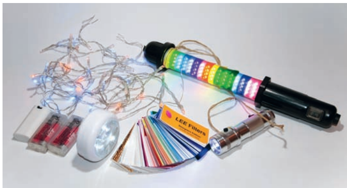
Oto mój podstawowy sprzęt: zasilane bateryjnie kolorowe lampki choinkowe, lampa warsztatowa z diodami LED pokrytymi różnokolorowymi foliami i świecąca w różnych kolorach mocna latarka LED
