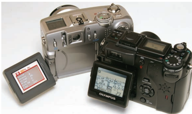
Rysunek 1.3. Przegubowe wyświetlacze LCD po raz pierwszy zostały zastosowane w kamkorderach, a dopiero stamtąd zostały zaadaptowane dla potrzeb aparatów cyfrowych.
