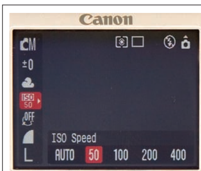
Rysunek 1.4. Niektóre aparaty cyfrowe oferują specjalne menu umożliwiające wybranie czułości urządzenia na światło. Często jest ono oznaczone nazwą „ISO”, która odwołuje się do czułości tradycyjnych klisz fotograficznych
