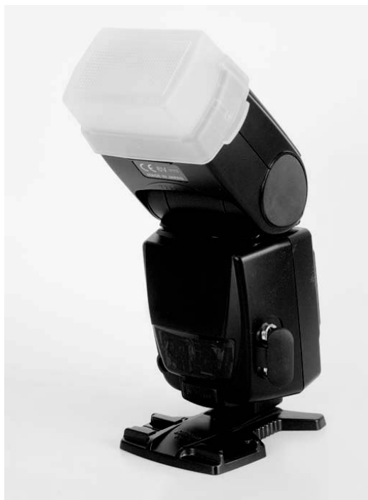
Rysunek 1.5. Zewnętrzną lampę błyskową można zamontować na aparacie lub poza nim, łącząc oba urządzenia odpowiednim przewodem — takie rozwiązanie umożliwia oświetlenie obiektu pod innym kątem
