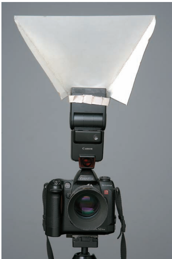
Rys. 3.30. Ten ekran odbijający został wykonany z wyjętej z opakowania koszuli tekturki o wymiarach 8,5 × 11 cali
