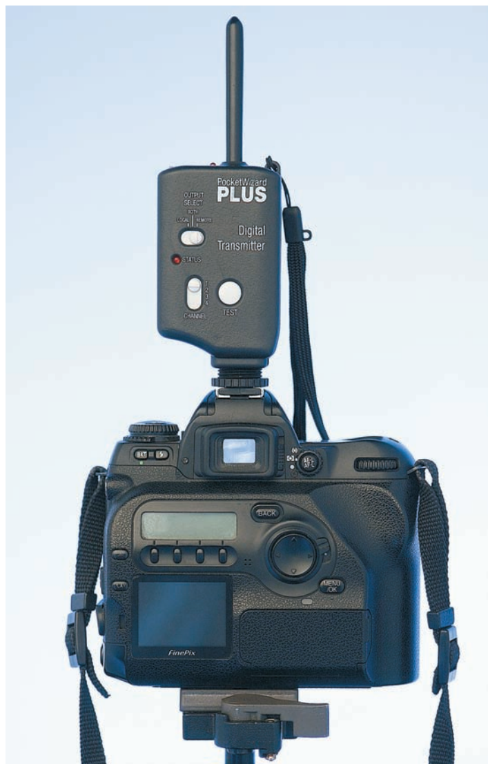
Rys. 3.7. Nadajnik wyzwalacza radiowego jest montowany w „gorącej stopce” aparatu i służy do zdalnego wyzwalania lampy błyskowej przy użyciu sygnału radiowego
