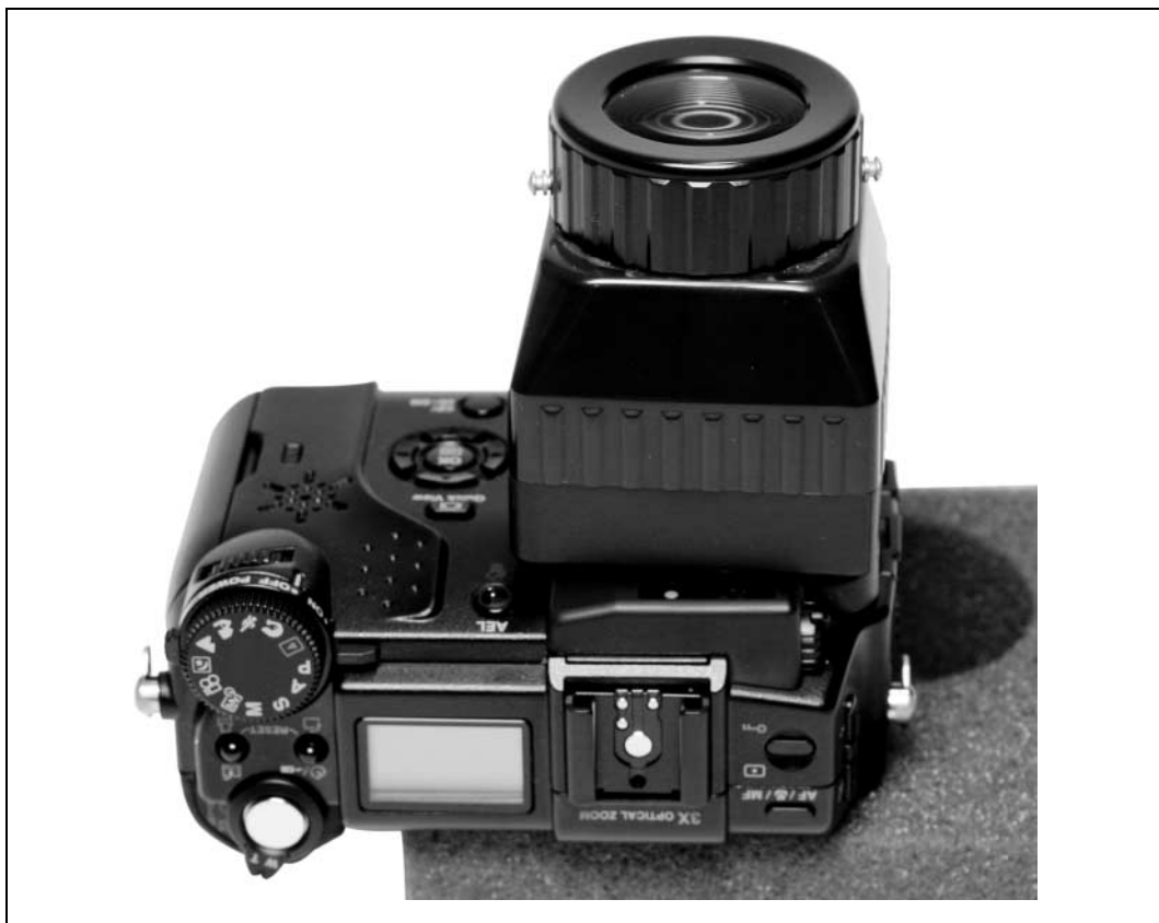
Rysunek 1.11. Szkło powiększające wykorzystane w charakterze osłony wyświetlacza LCD
