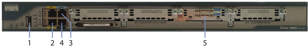
Rysunek 11.1. Panel z różnymi interfejsami routera: 1 — port USB, 2 — interfejsy Fast Ethernet, 3 — port konsoli, 4 — port AUX, 5 — interfejsy szeregowy
