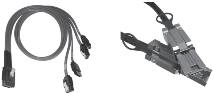
Rysunek 2.51. Przykładowy 36-pinowy przewód Mini-SAS SFF-8087 umożliwiający podpięcie 4 dysków twardej (z lewej) oraz zewnętrzny 26-pinowy przewód Mini-SAS SFF-8088 stosowany do połączenia zewnętrznych macierzy dyskowych (z prawej)
