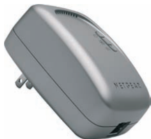
Rysunek 1.4. Klockowaty adapter Powerline Ethernet pozwala podłączyć komputer do sieci równie łatwo jak suszarkę do włosów do prądu. Wystarczy włożyć adapter do najbliższego gniazdka elektrycznego i jeden koniec kabla Ethernet do gniazda na dole obudowy, a drugi do komputera.
