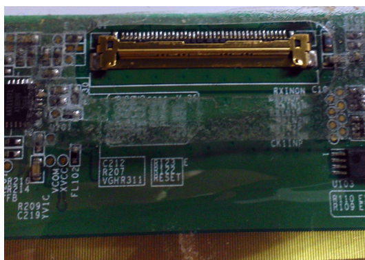
Złącze LVDS 40-pin matrycy z podświetlaniem LED
