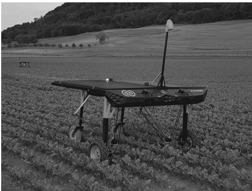
Rysunek 1.4. Autonomiczny robot mobilny do pielenia chwastów (dzięki uprzejmości firmy Ecorobotix)
