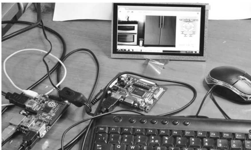
Rysunek 5.3. System komputerowy oparty na Raspberry Pi
