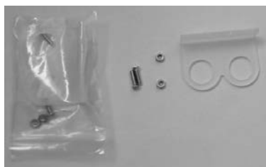
Rysunek 8.8. Wsporniki czujnika ultradźwiękowego HC-SR04 ze śrubkami i nakrętkami
