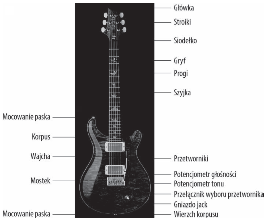
RYСУNEK 1.2. Typowa gitara elektryczna z oznaczonymi najważniejszymi częściami
