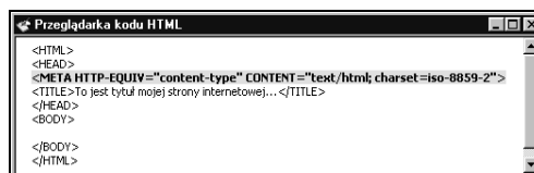
Rysunek 11.11. Bardzo ważny znacznik (element sekcji HEAD ), którego nadanie jest niezbędne, by polskie znaki na stronie internetowej były wyświetlane w sposób prawidłowy
