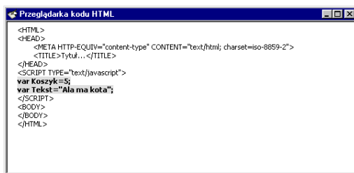
Rysunek 5.5. Deklarowanie zmiennej z jednoczesnym określeniem jej typu oraz nadaniem jej wartości
