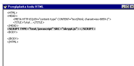
Rysunek 5.13. Odwołanie do zewnętrznego skryptu w treści dokumentu HTML
