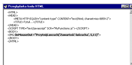
Rysunek 5.23. Wywołanie funkcji (jako reakcji na zajście zdarzenia) z argumentami typu łańcuch tekstowy — wykorzystano pojedyncze i podwójne cudzysłowy
