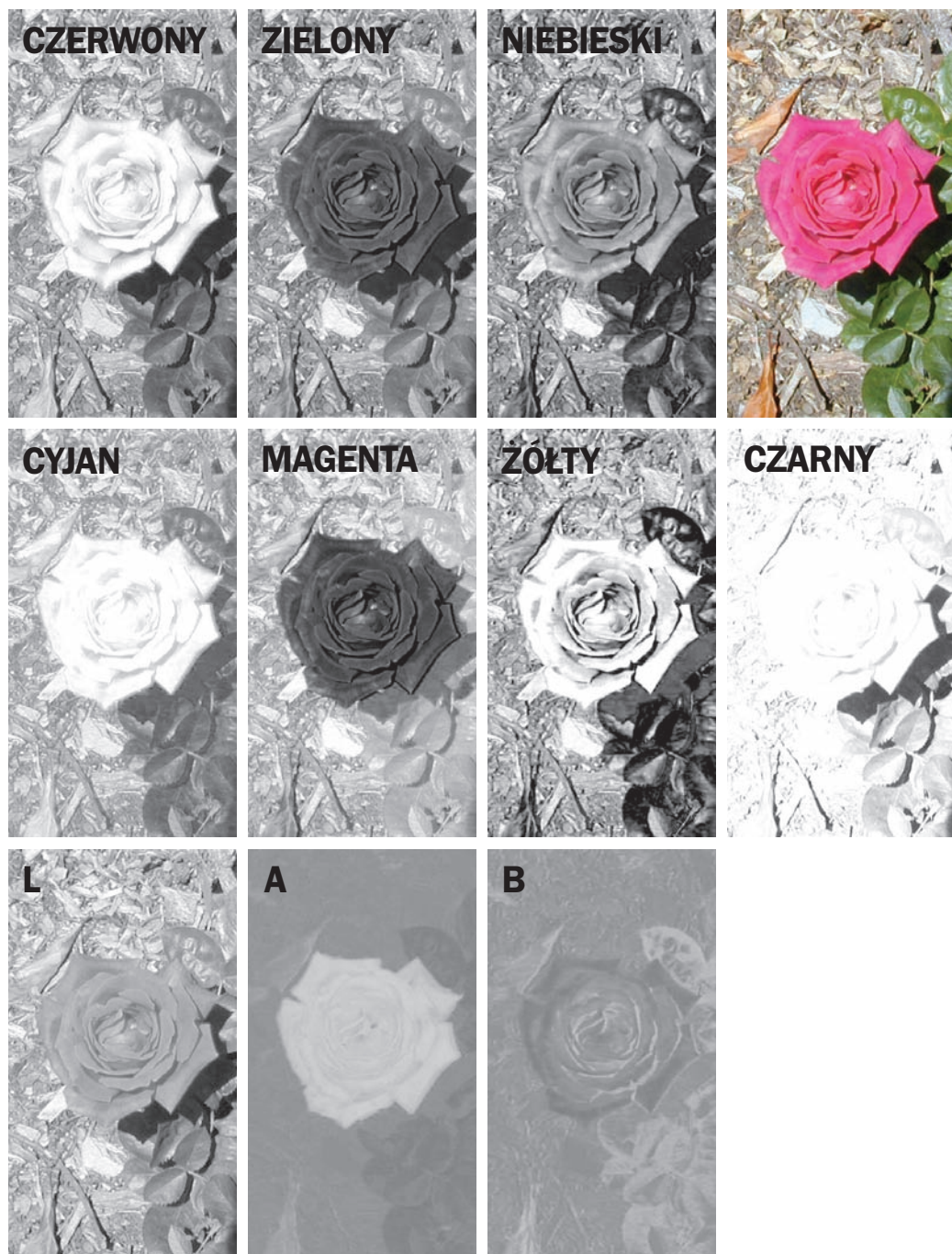
Rysunek 2.1. Na rysunku w prawym górnym rogu przedstawiono oryginalne zdjęcie róży. Rysunki w górnym rzędzie na lewo od tego zdjęcia obrazują kanały RGB składające się na tę fotografię — czerwony, zielony i niebieski. W rzędzie poniżej znajdują się ich odpowiedniki w przestrzeni CMYK — cyjan, magenta, żółty i czarny. Zwróć uwagę na podobieństwa występujące pomiędzy kanałem koloru czerwonego i cyjanu, zielonego i magenty oraz niebieskiego i żółtego. Kanały przestrzeni LAB pokazane w dolnym rzędzie są jednak zupełnie inne
