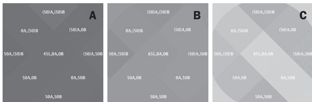
Rysunek 2.7. Kolorowe diagramy pokazane na rysunku 2.6 w trybie LAB miały identyczną jasność na całej powierzchni. Po przekształceniu do innych przestrzeni koloru ich jasność nie jest już taka sama, ze względu na konieczność skompensowania odcienia niektórych barw w sposób umożliwiający ich wydrukowanie. Efekt ten szczególnie dobrze widać na najjaśniejszym spośród diagramów, gdzie jasność każdego koloru (oprócz żółtego) uległa pewnym zmianom. Obrazki z diagramami zostały przekształcone nie z trybu LAB, lecz pośrednio, z plików CMYK przeznaczonych do wydruku
