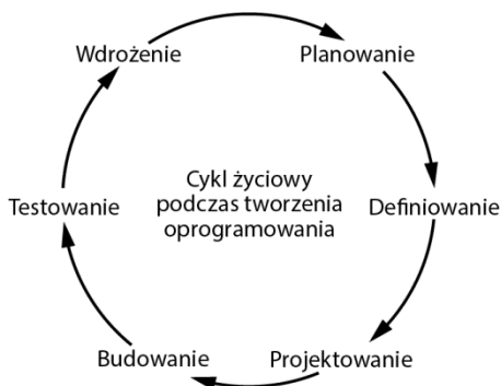
Rysunek 1.1. Sześć faz koncepcyjnych projektu oprogramowania, na podstawie oficjalnego standardu IEEE (Institute of Electrical and Electronics Engineers) inżynierii oprogramowania
