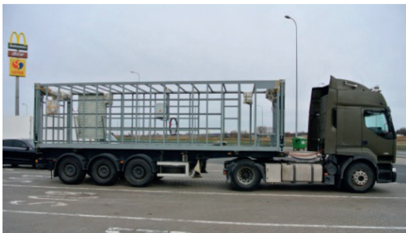
Rys. 2. Widok podwozia używanego w trakcie projektu – pierwsze próby trakcyjne ze szkieletem kontenera
