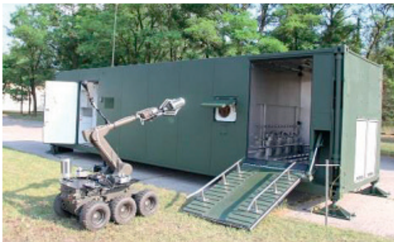
Rys. 1. Widok Mobilnego Laboratorium do Poboru Próbek Środowiskowych – zabudowa na kontenerze 30’
