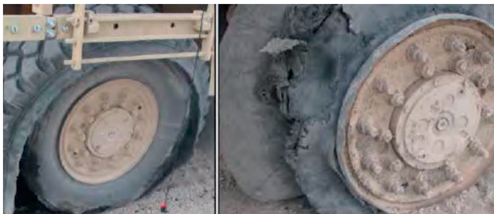
Rys. 9. Widok kół z wkładkami nośnymi po badaniach [38]
