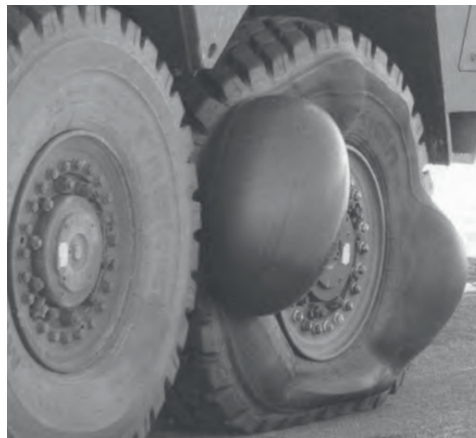
Rys. 5. Negatywne skutki jazdy bez wymaganego ciśnienia napompowania [28]
