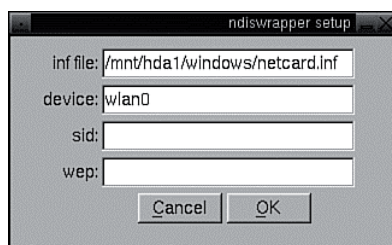
Rysunek 4.20. W przypadku kart bezprzewodowych obsługiwanych przez program Ndiswrapper należy wprowadzić ścieżkę dostępu do pliku .inf dla danej karty
