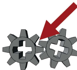
Rysunek 1-3: Luz w postaci przerwy między zębami dwóch stykających się kół zębatych jest szczególnie duży w przypadku kół o 8 zębach.
