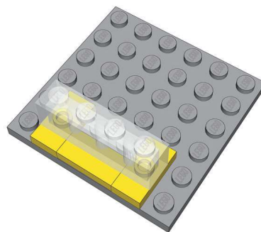
Rysunek 2-22: Użycie płytki ze studem pośrodku do umieszczenia klocka przesuniętego o pół studa
