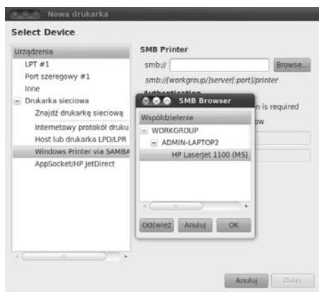
Rysunek 2.15. Drukarka sieciowa udostępniana na Windows 7 (admin-laptop2) — konfiguracja
