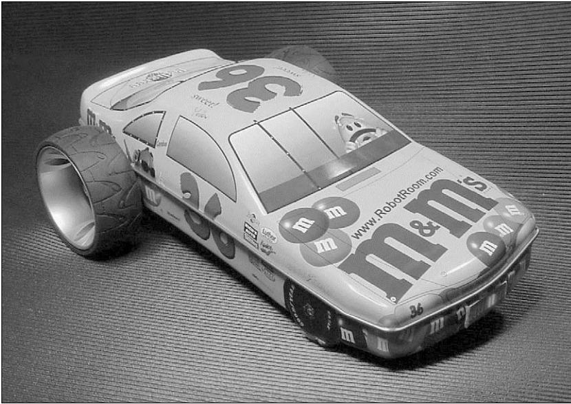
Rysunek 1.12. Robot podążający wzdłuż linii w obudowie z pudełka po cukierkach
