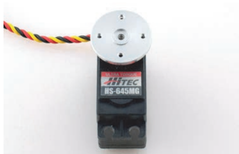
Rysunek 5.5. Serwomotor ustawiony w pozycji 90° z poprawnie założoną nasadką
