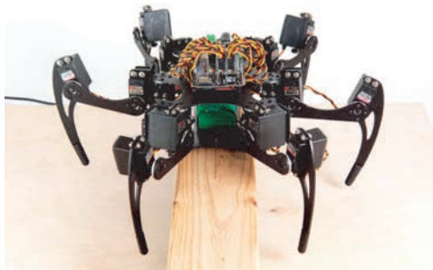
Rysunek 5.9. Zamontowane segmenty piszczelowe i serwowatory wszystkich stawów ustawione pod kątem 90°
