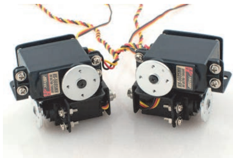
Rysunek 5.6. Zmontowane stawy biodrowe
