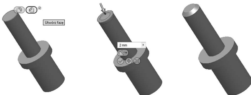
Rysunek 4.12. Ścięcie krawędzi na modelu bryłowym wałka
