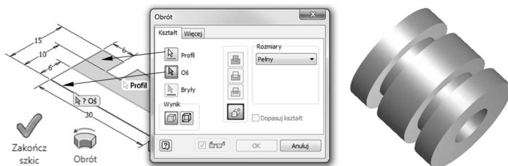
Rysunek 4.17. Generowanie modelu bryłowego tulejki
