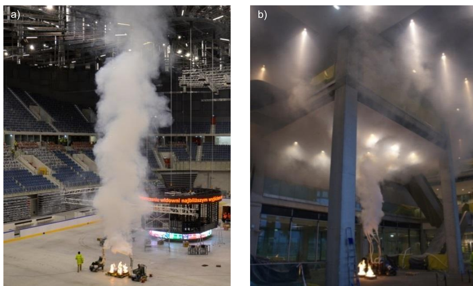
Fot. 1. Przepływ dymu w układzie przegród budowlanych a) prosty układ przegród, b) skomplikowany układ przegród; widoczna jest różnica w ilości dymu płynącego w obszarze kolumny konwekcyjnej (osiowo-symetrycznej) a wypływem z krawędzi przegrody poziomej (fot. Autora)
