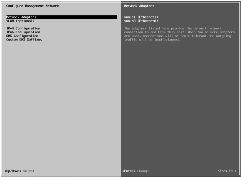
RYSUNEK 5.11. Z poziomu menu Configure Management Network użytkownicy mogą modyfikować przypisane karty sieciowe, zmieniać identyfikator VLAN-u, adres IP, serwery DNS oraz konfigurację wyszukiwania DNS
