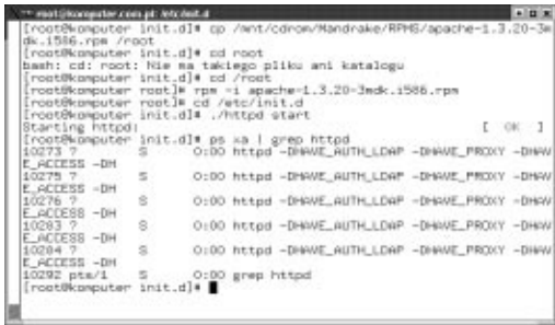
Rysunek 4.7. Uruchomienie serwera Apache z wiersza poleceń
