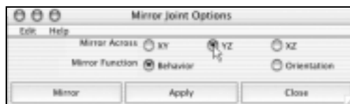
Rysunek 9.12. Wybrana opcja YZ umożliwia utworzenie odbicia lustrzanego względem płaszczyzny YZ
