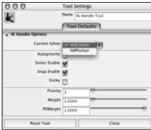
Rysunek 9.26. Okno Tool Settings narzędzia IK Handle Tool z wybranym analizatorem typu SC. Ten typ analizatora nie sprawia problemów z odwracaniem, jak robił to analizator RP
