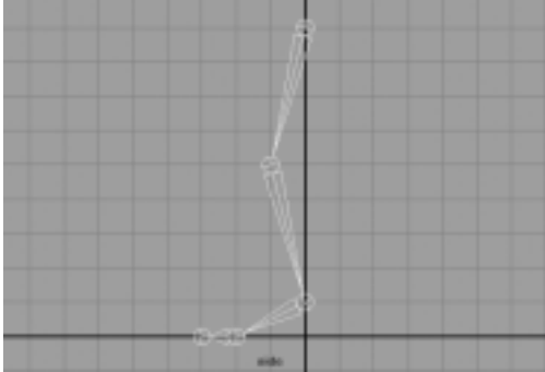
Rysunek 9.8. Oto typowy szkielet nogi. Rozpoczynając od szczytu hierarchii poszczególne przeguby noszą nazwy: biodro, kolano, kostka, śródstopie, palec. Jeżeli postać będzie nosić buty, nie ma potrzeby tworzenia kości dla każdego palca z osobna. Jedna kość jest w zupełności wystarczająca do zginania przedniej części buta
