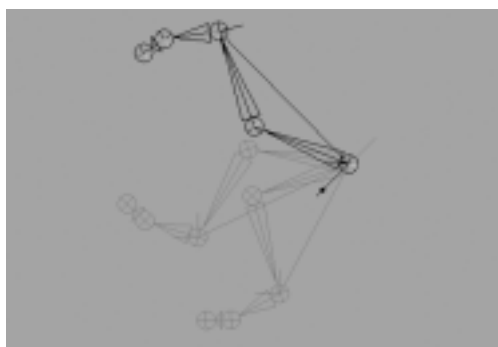
Rysunek 9.24. Przemieszczenie chwytu RP IK może spowodować odwrócenie kończyny w przeciwnym kierunku
