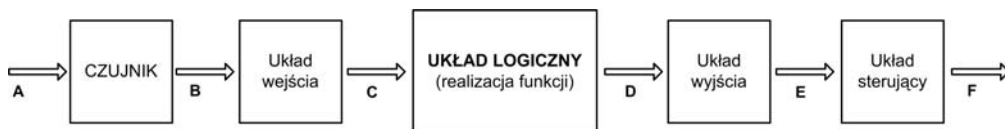
Rysunek 2.6. Przykładowy system z wykorzystaniem układu logicznego
