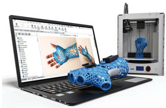
RYСУNEK 3.12. Proces tworzenia opatrunku „gipsowego” w przypadku uszkodzenia kości dłoni. Zastosowane zostały techniki skanowania 3D, modelowania CAD i druku 3D
