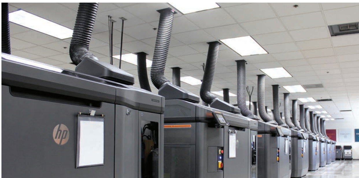
RYSUNEK 3.14. Rząd drukarek 3D HP Multi Jet Fusion. (Dzięki uprzejmości Forecast 3D)
