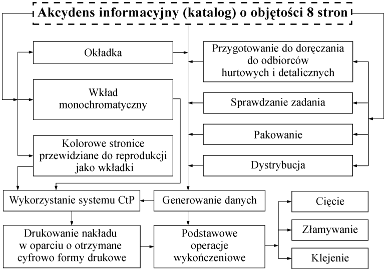
Rysunek 1.2. Diagram z głównymi węzłami opisującymi elementy konkretnego cyklu produkcyjnego
