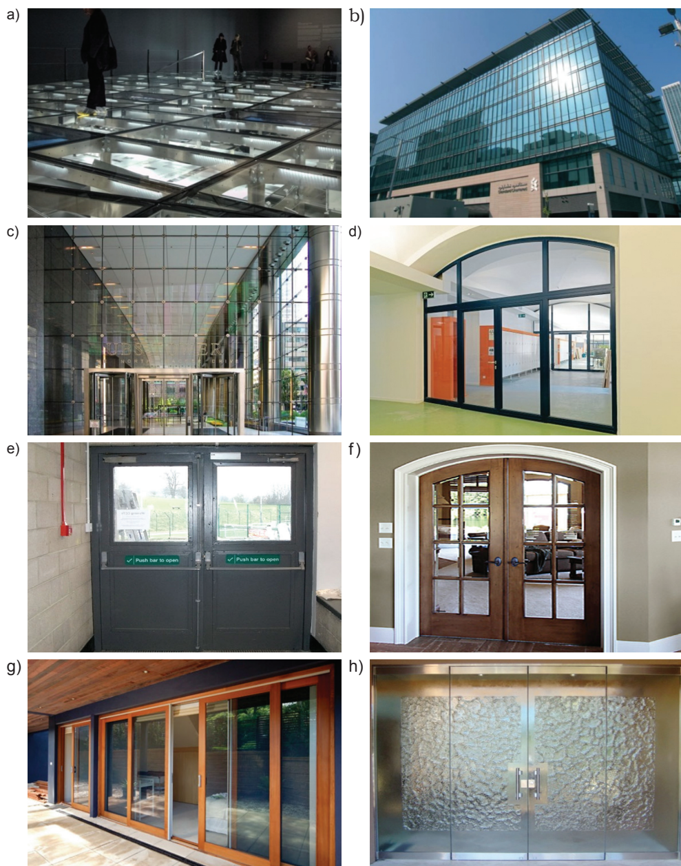
Rys. 2. Przykładowe zastosowania przegród przeszklonych a) szklany strop, b) przeszklona ściana osłonowa słupowo-ryglowa, c) przeszklona ściana osłonowa z połączeniami strukturalnymi, d) stalowe profilowe drzwi przeszklone z przeszklonymi panelami górnymi i bocznymi, e) stalowe płaszczyznowe drzwi przeszklone, f) drewniane drzwi przeszklone, g) drewniane przesuwne drzwi przeszklone, h) drzwi „całoszklane” [93]
