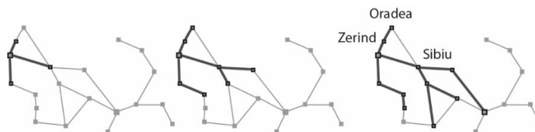
RYSUNEK 3.5. Sekwencja wybranych etapów rozwojowych drzewa wyszukiwawczego generowanego przez graf z rysunku 3.1. Na każdym etapie rozwijamy wszystkie węzły tworzące granicę, rozszerzając w ten sposób ścieżki, ograniczając się do akcji, które mają sens i nie prowadzą do któregoś ze stanów już osiągniętych. Zauważmy, że w trzecim etapie rozwinięcie węzła Oradea doprowadziłoby do wygenerowania dwóch węzłów potomnych, reprezentujących stany już osiągnięte (Zerind i Sibiu), dlatego rezygnujemy z tego rozwinięcia
