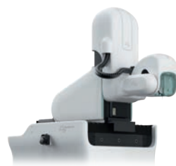
Rysunek 5.22. Robot chirurgiczny Neuralink do implantacji elektrod w korę mózgową [35]
