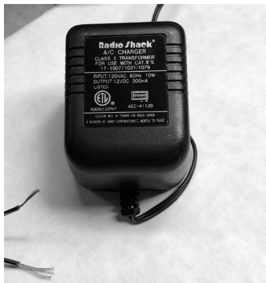
Rysunek 5.2. Zasilacz transformatorowy AC/DC
