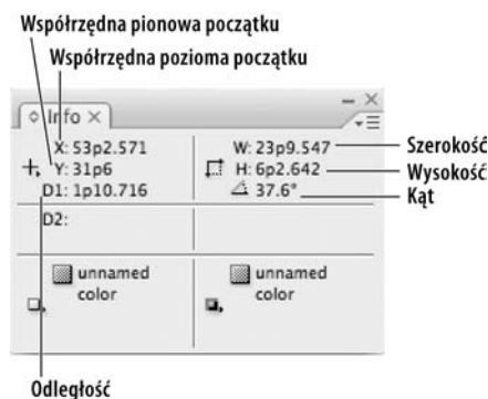
Rysunek 4.77. Dane na temat pomiaru wykonanego narzędziem Measure (Miarka), wyświetlone w panelu Info ( Informacje )
