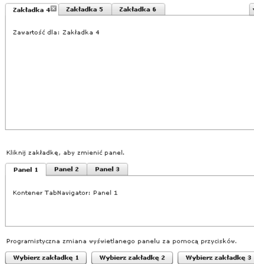
Rysunek 2.1. W bibliotece FlexLib dostępny jest komponent SuperTabNavigator (na górze), który rozszerza możliwości domyślnej kontrolki TabNavigator (na dole) o takie funkcje, jak przemieszczanie zakładek, zamykanie ich oraz przemieszczanie poza widoczny obszar okna
