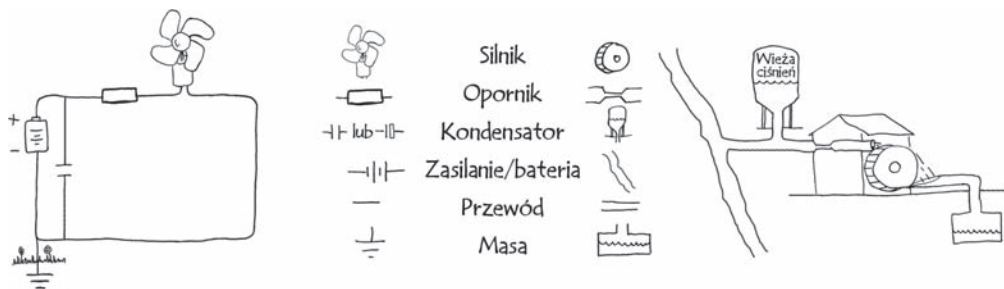
RYСУNEK 5.4. Porównanie obwodu elektrycznego do nurtu wody
