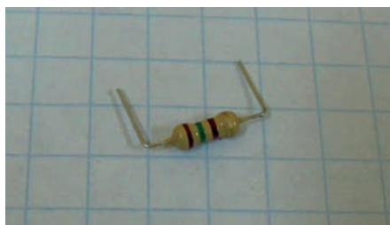
Rysunek 2.50. Rezystor z odpowiednio wygiętymi i przyciętymi końcówkami
