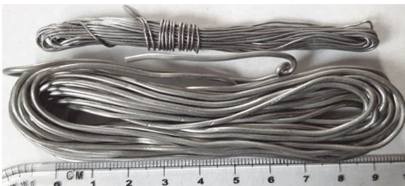
Rysunek 1.12. Cienkie lutowie lepiej sprawdzi się przy montażu układów elektronicznych. Z grubszego będzie wygodniej korzystać podczas lutowania instalacji CO i CW
