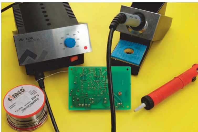
Rysunek 1.18. Stacja lutownicza
