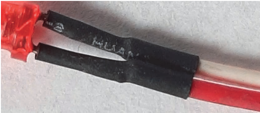
Rysunek 1.14. Połączenie zaizolowane z wykorzystaniem koszulek termokurczliwych
