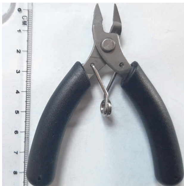
Rysunek 1.6. Cienkie zakończenia ułatwiają precyzyjne operowanie narzędziem
