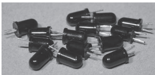
RYСУNEK 10.29. Diody LED z końcówkami przyciętymi na minimalną długość
