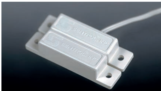
Rysunek 3.12. Typowy zestaw kontaktronowy do sygnalizowania otwartych drzwi lub okna. Na pierwszym planie znajduje się moduł magnetyczny, a na drugim — kontaktronowy
